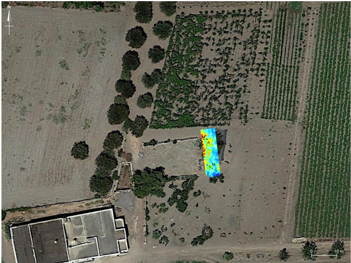
Fig. 26. Grottaglie. Intervento 10. Area 2A: georeferenziazione della depth slice più significativa relativa alla profondità di 1,70-1,90 cm (antenna da 600 MHz) con indicazione delle probabili strutture murarie sepolte (M) e possibile pavimentazione (A).
