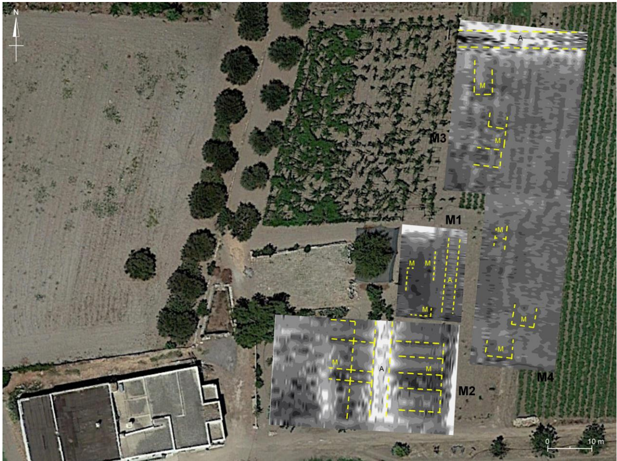
Fig. 43. Grottaglie. Intervento 10: visualizzazione complessiva dei dati acquisiti mediante strumentazione magnetometrica, interpretati e georeferenziati, relativi alle aree M1, M2, M3 ed M4.
