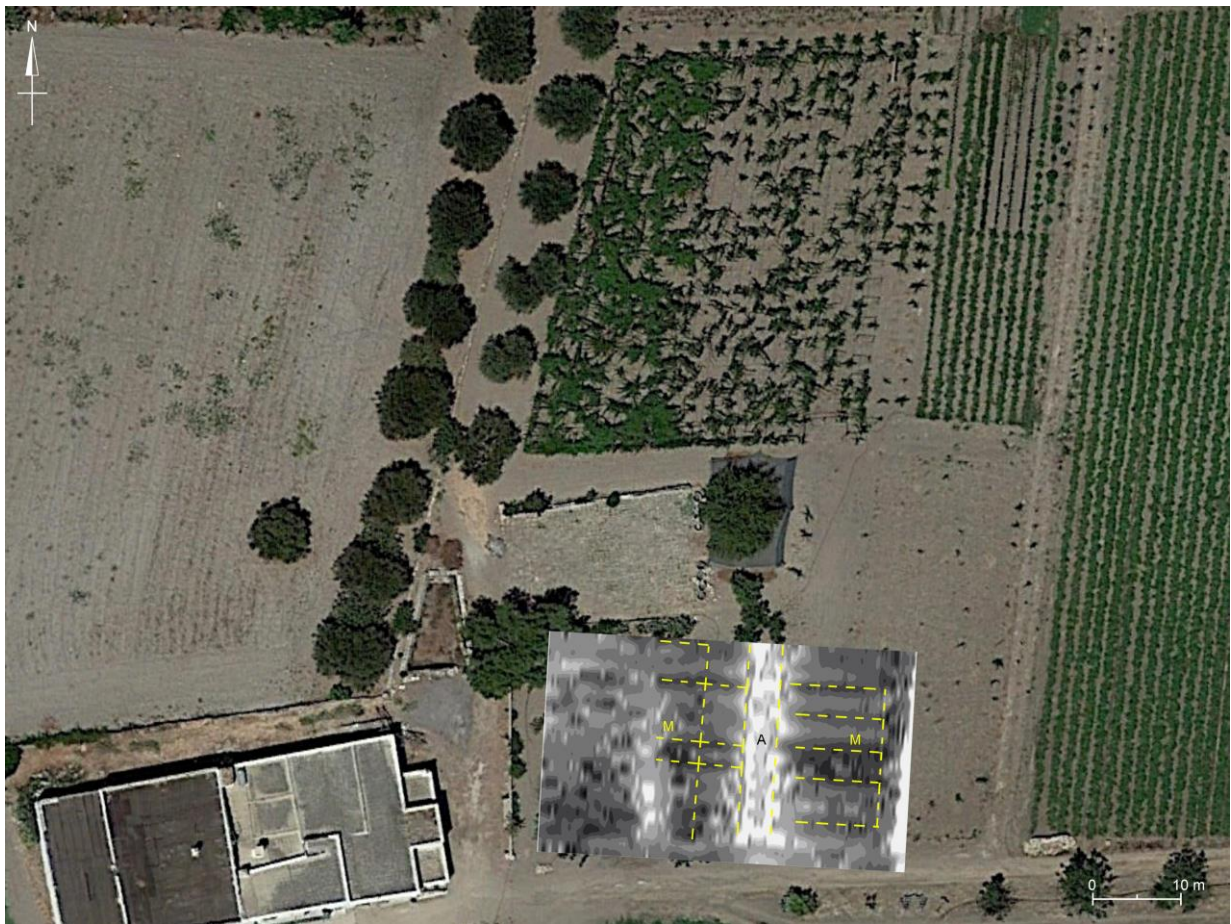
Fig. 39. Grottaglie. Intervento 10. Area M2: georeferenziazione dei risultati del rilievo gradiometrico.
