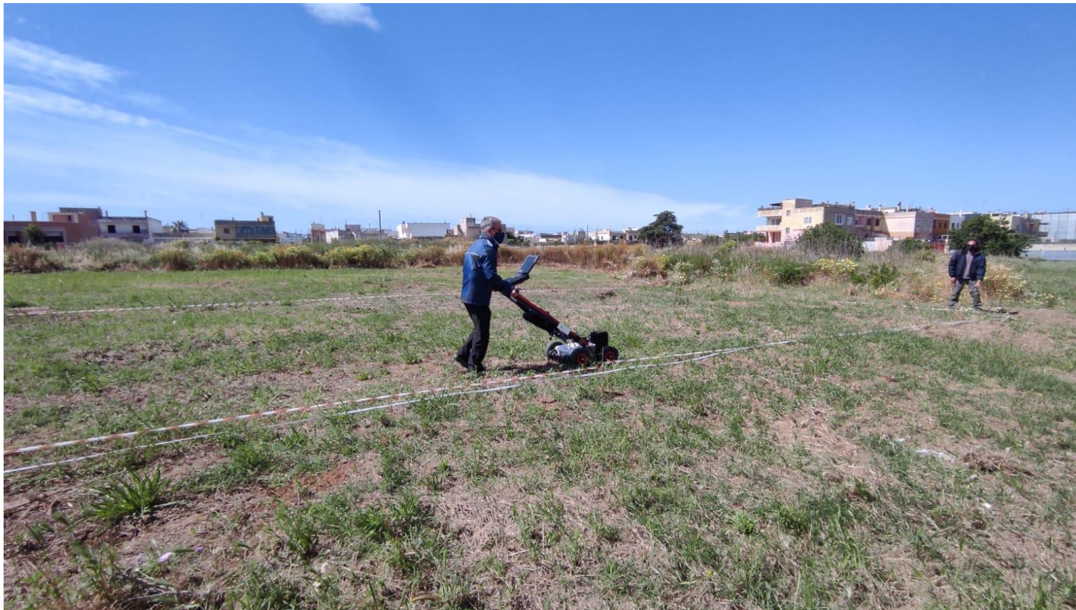
Figura 2: foto relativa alle fasi di rilievo georadar.
