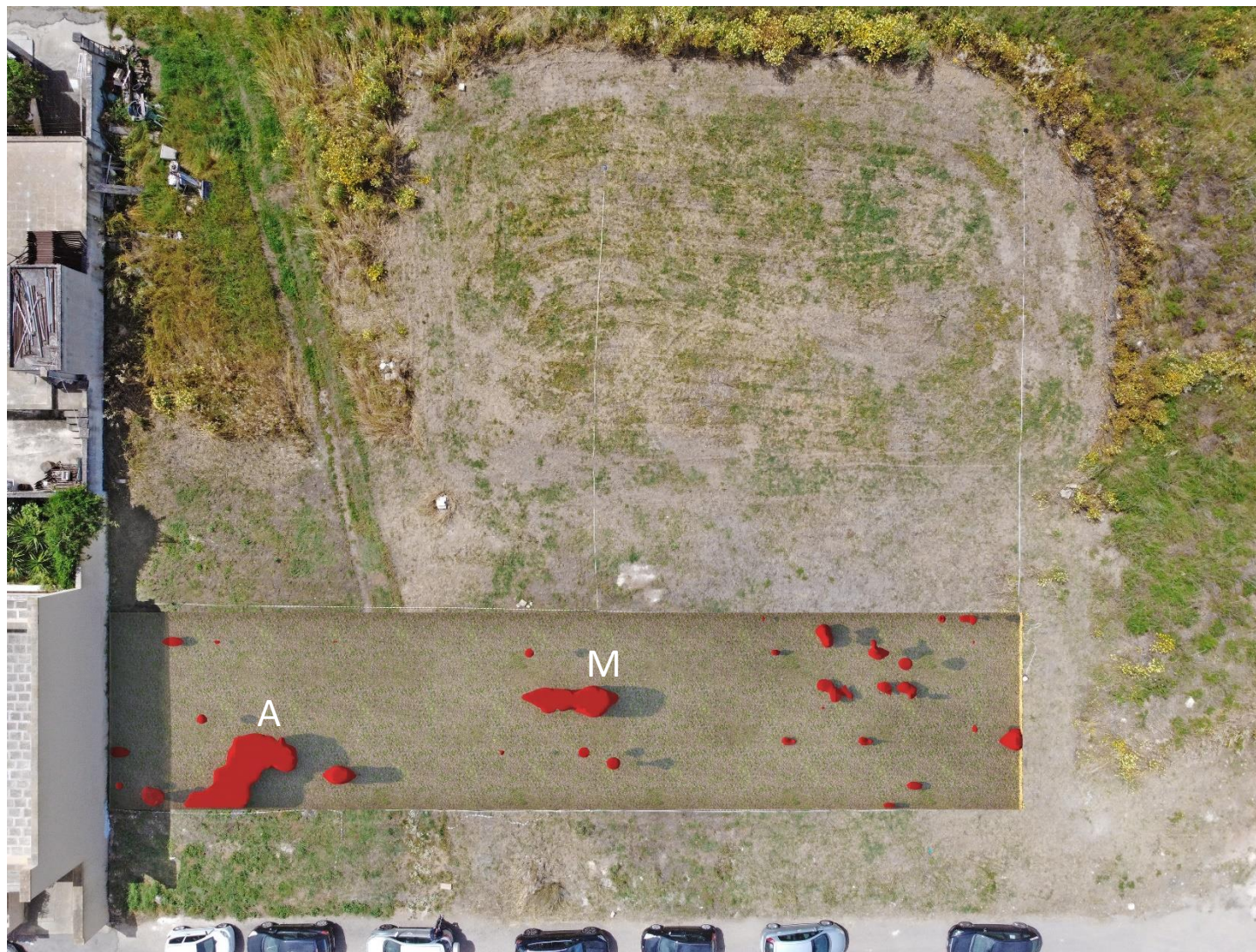
Figura 11: isosuperfici di ampiezza inserite in uno scavo virtuale .
