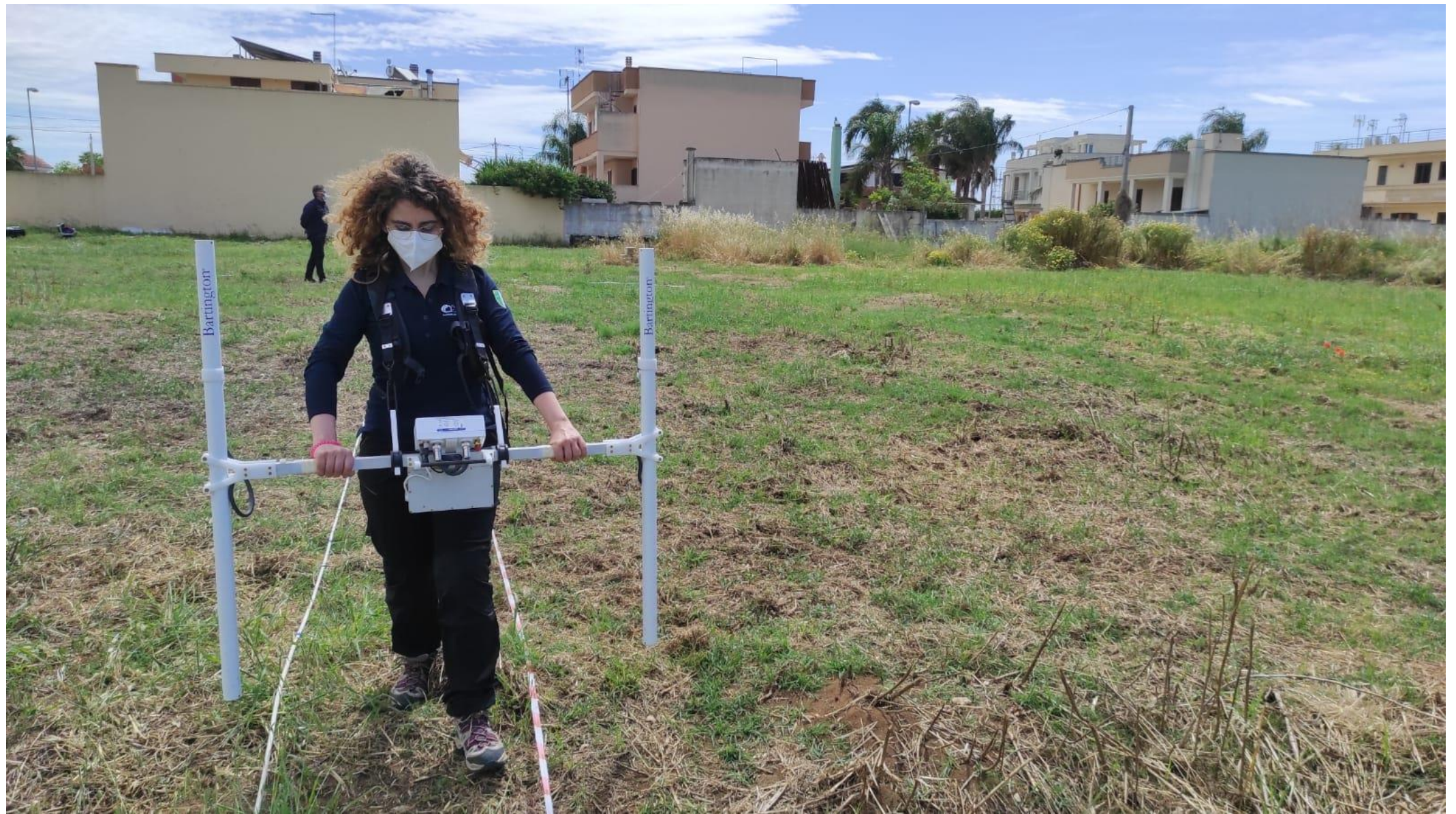
Figura 19: foto relativa alla esecuzione del rilievo gradiometrico.
